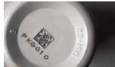
2D CODE PRINTED ON UNDERSIDE OF PLASTIC BOTTLE
