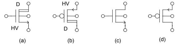
Fig. 1. Example of devices: (a) HV NDMOS (b) HV PDMOS (c) LV NMOS (d) LV PMOS
